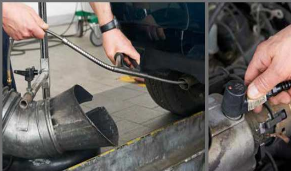
Osobní vozidla musejí v Německu každé dva roky projít měřením emisí. Při něm se na výfuk a na hlavu válců upevní čidla.
