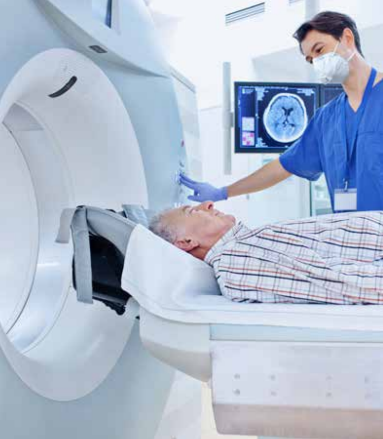
Flüssiges Helium kühlt Kernspintomografen
